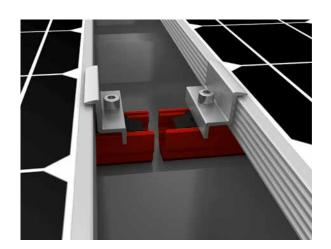
Nous recommandons une séparation thermique des modules tous les 13,60 m maximum de longueur de module dans le sens du faitage. Deux MultiRails 10 devront être fixés côte à côte sur la nervure. La distance entre les MultiRails fixés sur une même nervure doit être de 10mm minimum. Les étriers finaux doivent être fixés comme décrit à l'étape 5. Alternative : le 2ème MutliRail peut également être fixé sur la nervure suivante.
