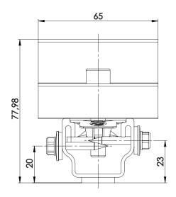
Pour les pentes > 30° / 58%, un dispositif anti-glissement pour éviter le glissement de l'écrou prisonnier MK2 et du module doit être installé sous la dernière ligne de modules. Monter 1 MultiRail à l'aide de 2 vis autoforeuses et un kit étrier final comme dans les étapes 1 à 5 décrites précédemment. Fixer deux vis traversantes sur le MultiRail pour éviter le glissement de l'écrou prisonnier MK2. Ajouter ce dispositif anti glissement sur chaque colonne de module.
