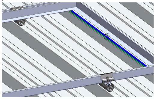
En cas de pénétration des câbles dans le bac acier, le passage des câbles vers l'intérieur du bâtiment doit être fait sans rompre l'étanchéité. Il se fera à l'aide de manchon d'étanchéité pour sortie de toiture d'épaisseur minimum de 2mm conforme aux spécifications du DTU 40.35 paragraphe 6.2.2.6.3. Chaque manchon sera installé au sommet de la nervure et devra être placé sous un module photovoltaïque. Il sera fixé avec un joint prévu à cet effet et des vis de couture.
