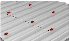
La distance X entre les MultiRails est définie en fonction des dimensions des modules et de leur zone de serrage autorisée. Il faudra consulter les recommandations de montage des fabricants de modules pour déterminer la zone de serrage.
