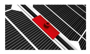
Utilisez des étriers intermédiaires XS entre deux modules. 13 mm entre les modules. Les vis requises pour l'étrier intermédiaire XS sont plus longues que celles d'un étrier standard.
