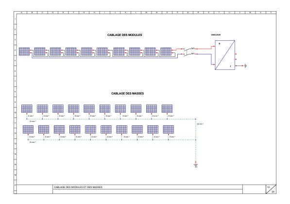
La liaison équipotentielle module / rail peut être réalisée en utilisant le système Terragrif. (pour plus de détails voir la fiche produit de la Terragrif)
